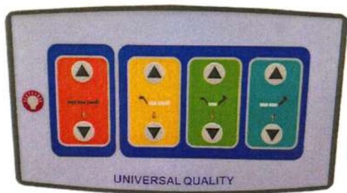
แผงควบคุมที่ราวข้างเตียง ด้านใน
