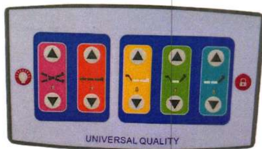
แผงควบคุมที่ราวข้างเตียง ด้านนอก
